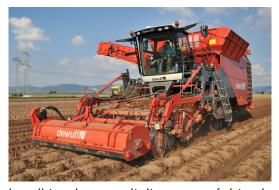
Potato Europe staat dit jaar in teken van de bodem, iets waar de Kwatro dagelijks garant voor staat dankzij de 900mm brede rupsen die zorgen voor een minimale bodemdruk. Dankzij de positionering van het rooikanaal voor de rupsen, blijft de aardappelkwaliteit gegarandeerd en bent u zeker van een succesvol oogstseizoen, ook in extreem natte omstandigheden. De aanzienlijke bunker van 17,5m³ verzekert een optimale productiviteit en
