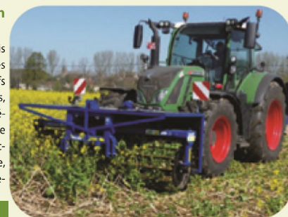
Photo 5: Destruction de moutarde au moyen d'un rouleau à lames
