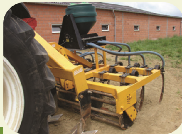
Photo 4: Montage du semoir sur un décompacteur
