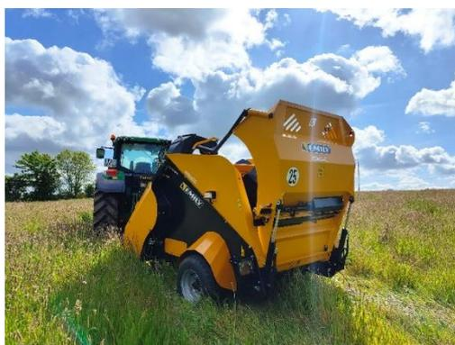
de fourrage. La Vortex est également équipée du système V-Cut (brevet Emily) de coupe des filets et ficelles. L'extraction des filets et ficelles est facilitée en paille et en foin. Ses béquilles de retenue sont rotatives à l'infini avec un mécanisme anti-retour.
